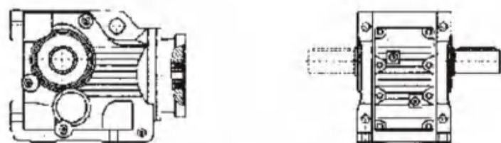
MKA(MK, MKF, MKAF, MKAB, MKAZ) ..ZP... 电机用户自配或配特殊电机时需加联接法兰， 长度见第 页
